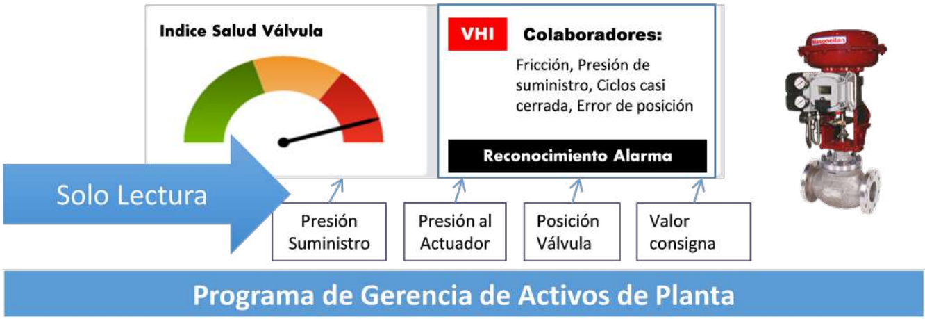
Figura 3. Índice de Salud de una válvula de control y parámetros considerados
