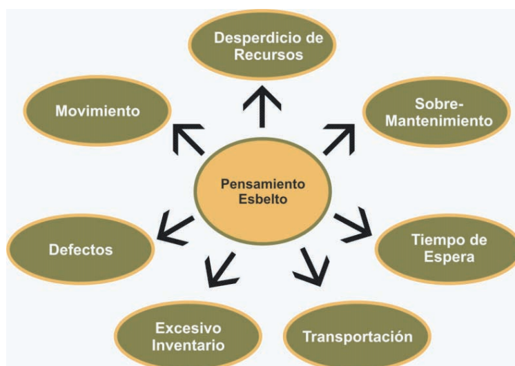
Figura 3. Áreas de desperdicio para aplicar el Pensamiento Esbelto en Mantenimiento
