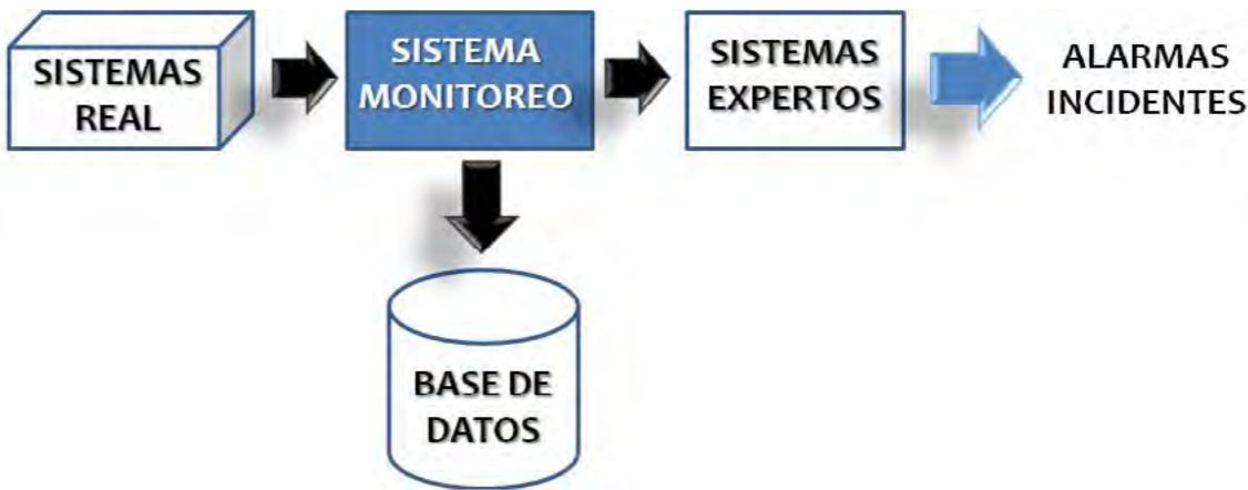
Figura 5. Sistema Experto Monitoreo por Condición (Amendola.L, 2003).
