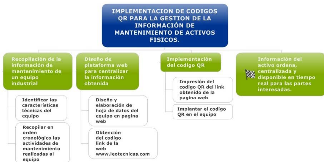
Figura 6: Metodología de implementación de códigos QR para la gestión de la información
