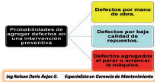
Figura 6. Probabilidades de agregar defectos durante una actividad de mantenimiento preventivo.
